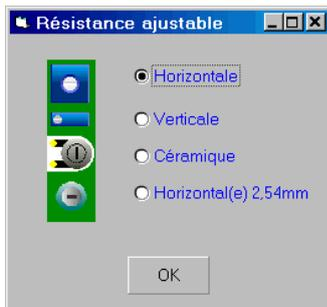
Quatre types de résistances ajustables sont possibles, horizontales (à plat), verticale (debout) aux pas de 5,08mm, céramique et horizontales au pas de 2,54mm, ce dernier choix est également utilisable pour les condensateurs ajustables. Le choix s'effectue en cliquant avec le bouton droit de la souris sur le bouton résistance ajustable sélectionné. Une fenêtre s'ouvre et quatre boutons radios permettent de faire la sélection.
